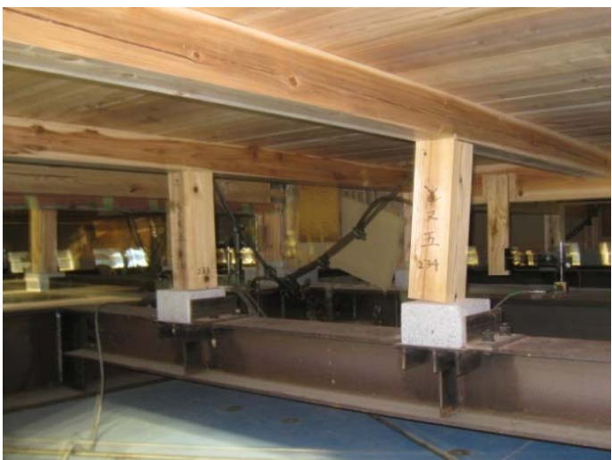
1階 と通り、又五 東石と束のずれ
