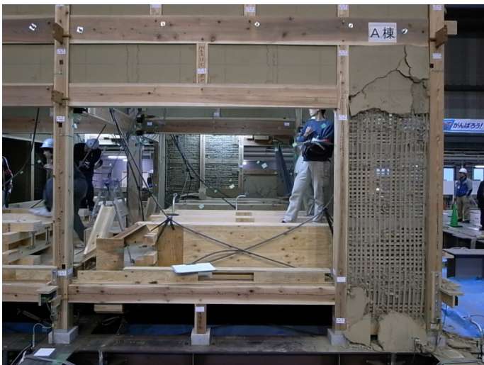
1階 七通り、い～ほ 土壁のひび割れと剥落
